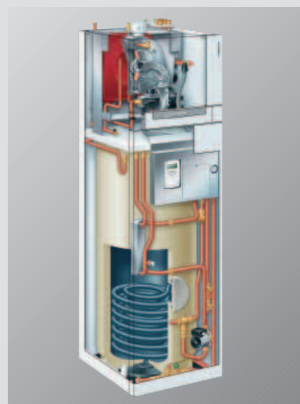
Afb. 45: Vitodens 343 – compacte energietoren van 4,2 tot 13,0 kW
